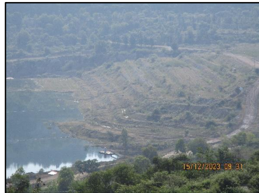
ภาพที่ 2.2 การเปิดหน้าเหมืองแบบขั้นบันได (Benching Method)
